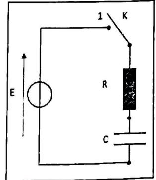
**Q31:** Le prof demande à l'un de ses élèves d'écrire au tableau les équations différentielles vérifiées par les grandeurs électriques du circuit ( $q$ ,  $i$ ,  $u_R$  et  $u_C$ ) quand l'interrupteur est mis en position (1). L'élève a écrit les quatre équations qui suivent. Seule l'une d'entre elles ne comporte pas d'erreurs, laquelle? Cocher la bonne réponse :
